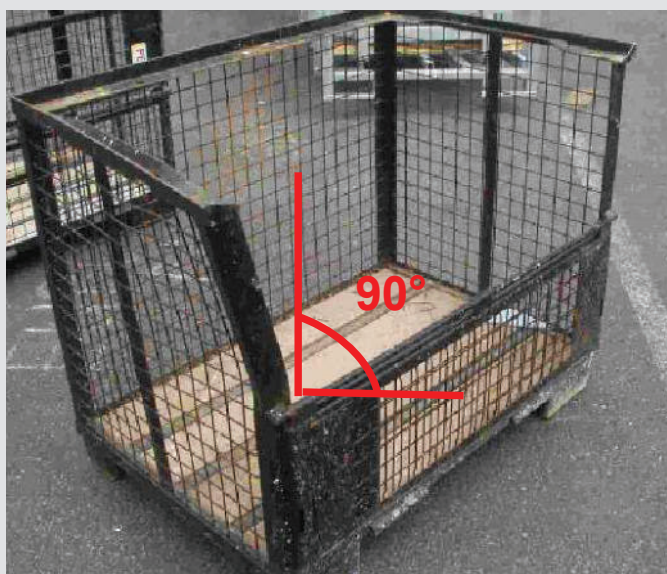
Montante piegato con angolo di inclinazione rispetto alla verticale > 1-2^\circ
