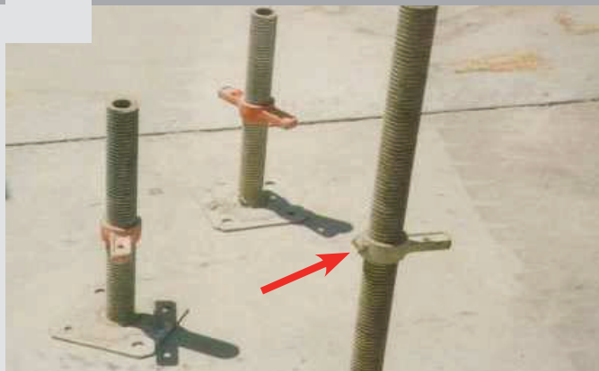
Rottura del dado a maniglia
