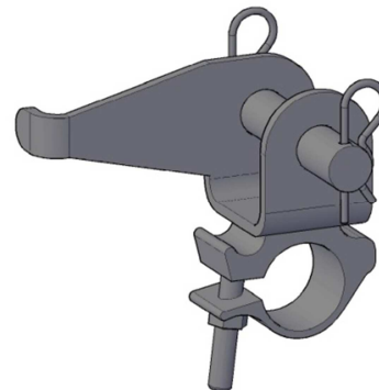
Figura 14 - supporto tubo \Phi 48 per corrente RCS
