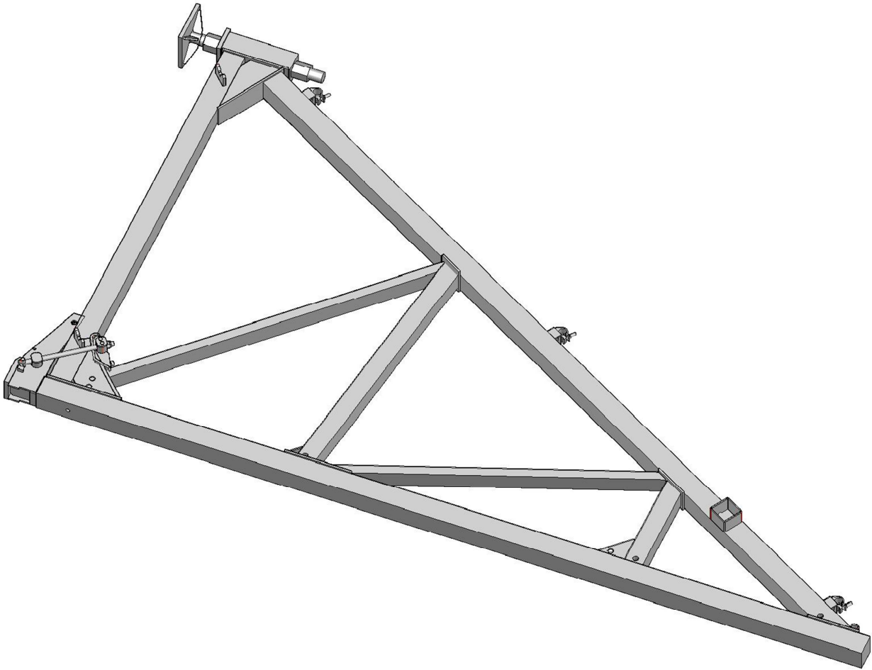
Figura 13 - Contrafforte SB2 completo
